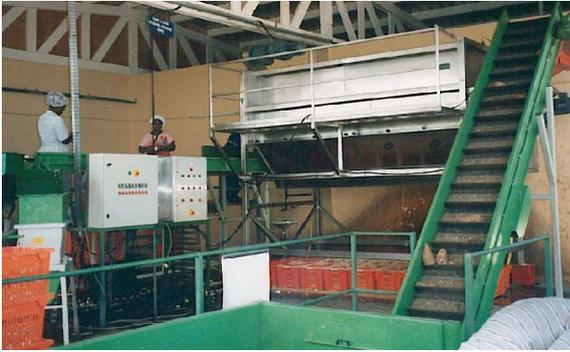
Gesamtansicht mit Vorratsbunker und Zuführband (vorne), DORNOW-Rollenschälmaschine (hinten) und Inspektion für geschälte Produkte (links).
