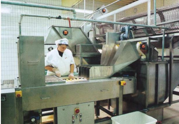
DORNOW-Kartoffelteilmaschine KT1E. Rechts oben im Bild eine vorgeschaltete Sortiertrommel für geschälte Kartoffeln. Rechts unten das Kartoffel-Vereinzelungs-Gerät VE-4R, welches die Kartoffeln regelmäßig auf die Teilmaschine fördert. Die genannte Teilmaschine kann sowohl Zwei- als auch Vierteilen.
