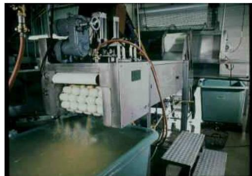
Die Kartoffelteilmaschine KT1E in Betrieb
