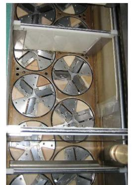
MSS-Schälmaschine mit Messer-Scheiben
