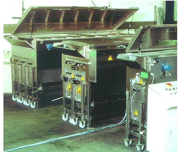
8 • Die MSS-Maschinen gibt es in 3 Größen: MSS-A mit einer, MSS-B mit zwei und MSS-C mit drei Schälstrecken, ausrüstbar mit Messer-, Karborund-, Zwiebel- und verschiedenen Sonder-Scheiben.
