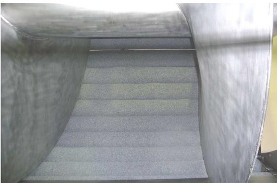
Blick in Rollenschälmaschine R-OW-190-A1, 14 Rollen, Ø 150, Schnecken-Ø 1900, Rollenlänge 4000 mm.
