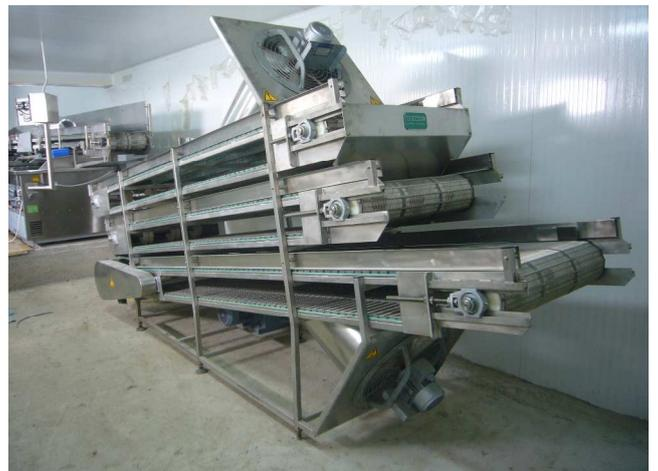
Kühlband, offene Konstruktion, Leistung ca. 500 kg/h
