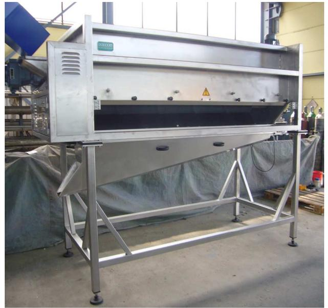
DORNOW-Rollenschälmaschine für Anlagen mit höherer Leistung und in weitgehend automatischen Linien
