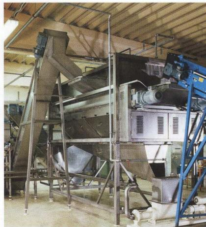
Ohne Abwasser arbeitende Rollenschälmaschine R-OW-110-A, Förderer für nochmals zu schälende Ware (links), Pumpe für Schalenbrei.
