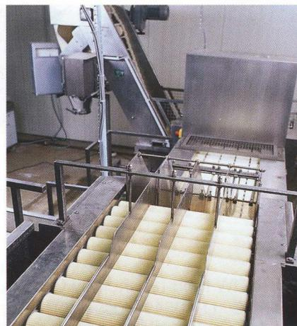
Rolleninspektionstisch, auf Wunsch mit Kanälen, Kartoffelteilmaschine, Konservierungs- und Absackgerät.
