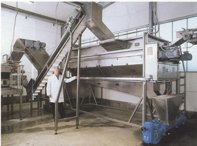
Rollenschälmaschine R-OW-60-A, Durchmesser Innenraum 600 mm, in einem gewerblichen Kartoffelschälbetrieb.
