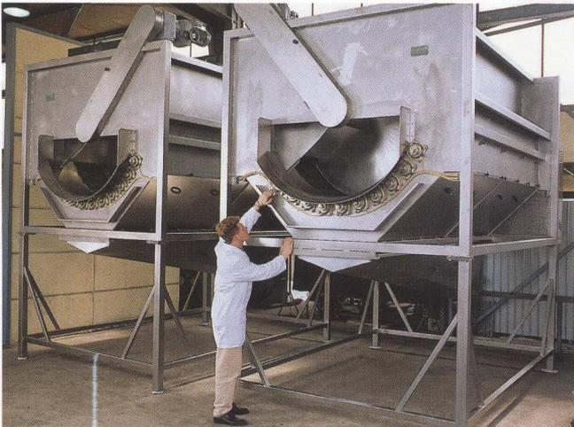
Zwei der größten Rollenschälmaschinen R-OW-150-A, Durchmesser der Innenräume 1500 mm.
