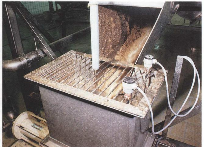
Kartoffelschälabfall, ohne Zusatz von Wasser, fließt in den Auffangbehälter einer Pumpe.
