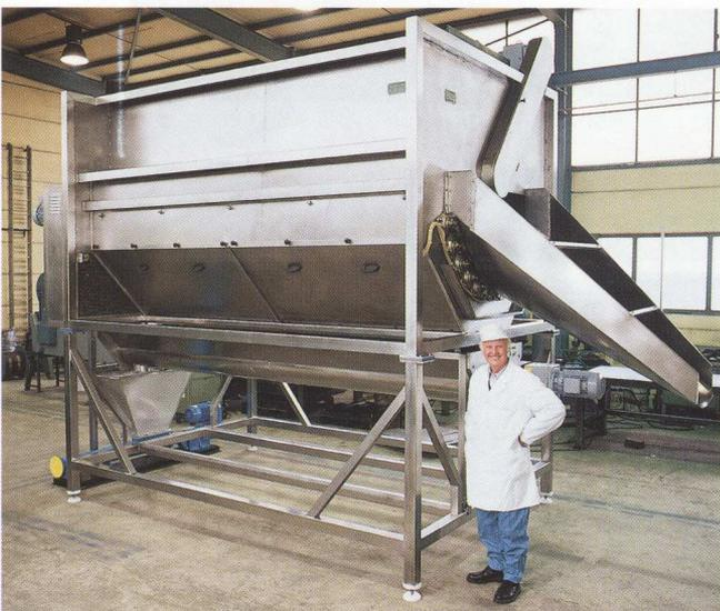
Rollenschälmaschine R-OW-150-A, Durchmesser Innenraum 1500 mm, zum Schälen von Sellerieknollen, rote Bete und Karotten.
